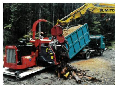
移動式チップパーによる残材チップ化
