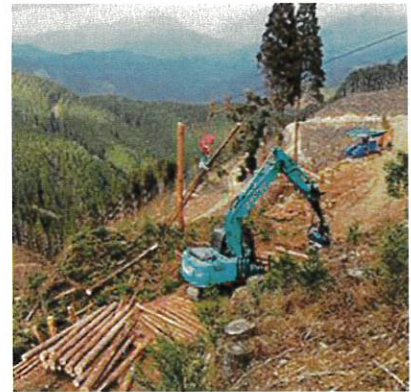
架線集材システム
