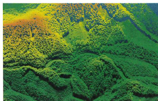
航空レーザ計測による点群画像
