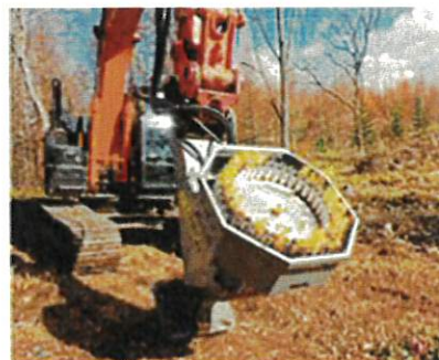
自動植付け機(苗の装填部)
