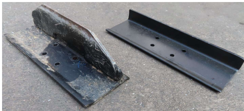
シン・ラプトル専用 標準シングルシュー シングルシュー
